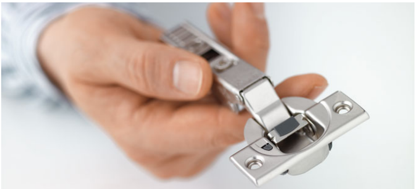
Eine Bohrtiefe von 13 mm für den Scharniertopf genügt.
